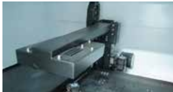
60度X光管与探测器同步倾斜
